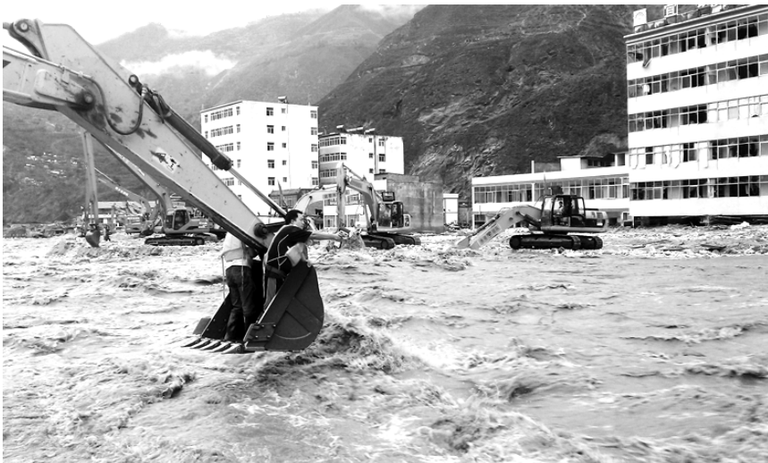
水文职工站在挖掘机上用超声波流速仪施测舟曲白龙江堰塞河道表面流速
